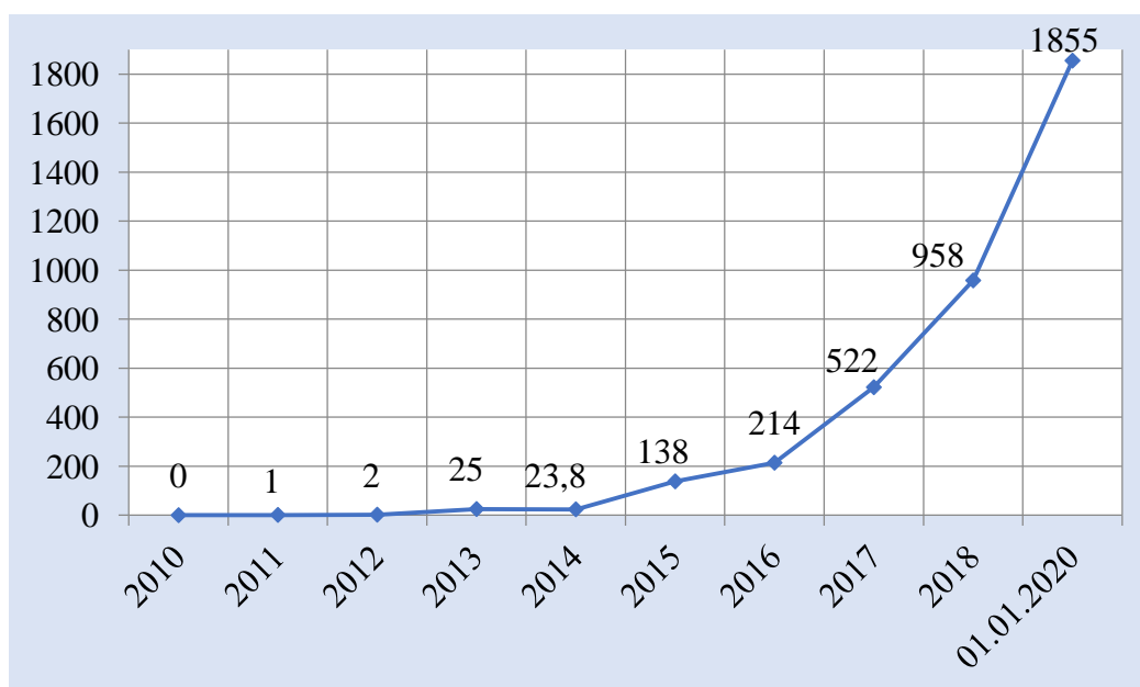
Рисунок 4.3 – Динамика установленной мощности объектов солнечной электроэнергетики в государствах-участниках СНГ в период с 2010 по 2020 год, МВт
